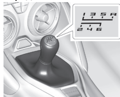
Схема переключения передач (двигатель V8)
