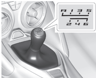
Схема переключения передач (двигатели L4 и V6)
